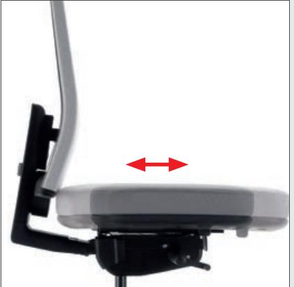
Il meccanismo di traslazione permette uno scorrimento sull'asse orizzontale del sedile di 73 mm., bloccabile nella posizione desiderata. (5 posizioni di blocco)
