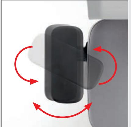
Il pad del bracciolo ruota a destra e a sinistra per ottenere un migliore appoggio dell'avambraccio. Inoltre, con la rotazione di 180°, la distanza interna aumenta di 40 mm.
